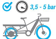
2. Czas pracy i parametry wydajnościowe są najlepsze, kiedy ciśnienie w oponach wynosi od 3,5 do 5 bar
