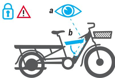
Avant d'insérer votre batterie dans son emplacement, vérifier qu'aucun objet ou corps étranger ne s'y trouve.
