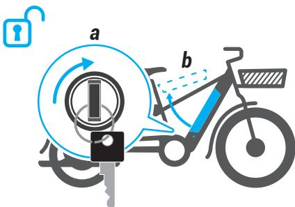
Prima di rimuovere la batteria dal relativo alloggiamento, sbloccarlo con l'apposita chiave.
