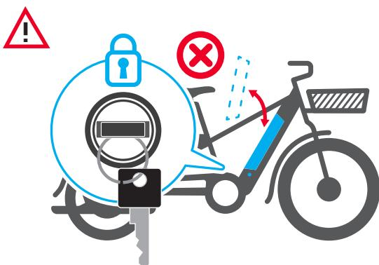
Probeer de batterij niet te plaatsen of te verwijderen wanneer hij vergrendeld is (horizontale positie van de sleutel): U loopt het risico de veiligheid van uw batterij te beschadigen.
