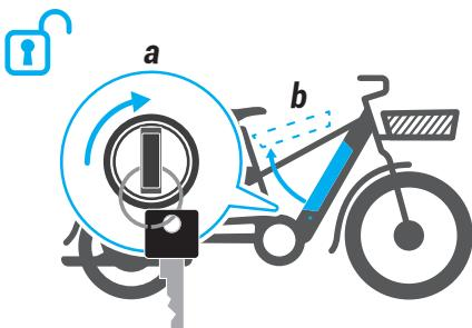
Ne zaboravite otključati bateriju prije nego je izvadite iz kućišta. Držite kijuč okrenut, a zatim izvadite bateriju povlačenjem.
