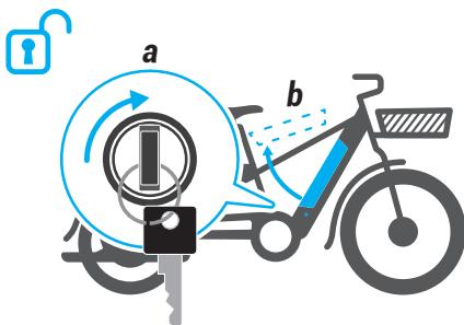
Voordat u uw batterij verwijdert, ontgrendelt u met de sleutel. Houd de sleutel in gedraaide stand en verwijder de accu door hieraan te trekken.
