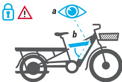
Innan du sätter batteriet på plats, kontrollera att inga främmande föremål eller material finns där.
