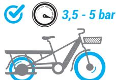
2. Pumpa upp däcken till mellan 3,5 och 5 bar för att öka batteritiden och effektiviteten
