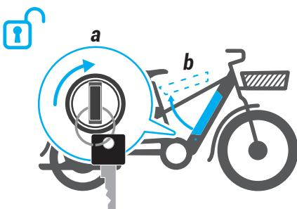
Înainte de a scoate bateria din locașul său, desculați-l cu cheia. Înțeță cheia învărtită, apoi scoateți bateria trăgând de ea.
