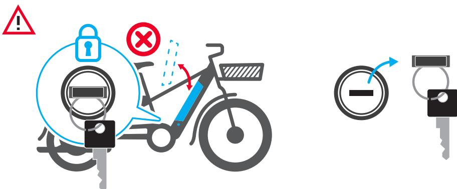
Nepokúšajte sa batériu vložiť alebo vybrať, keď je zámok uzamknutý (vodorovná poloha): Môže to zlomiť bezpečnostný zámok na batérii.
