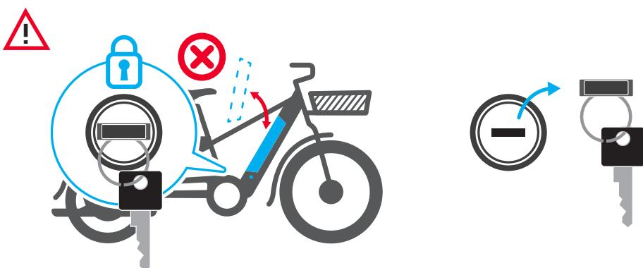
Versuchen Sie nicht, den Akku einzusetzen oder herauszunehmen, wenn das Schloss verriegelt ist (waagrechte Position). Dies würde die Sicherung des Akkus beschädigen.
