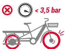
3. Nedovoljno naduvane gume više su osetljive na bušenje
