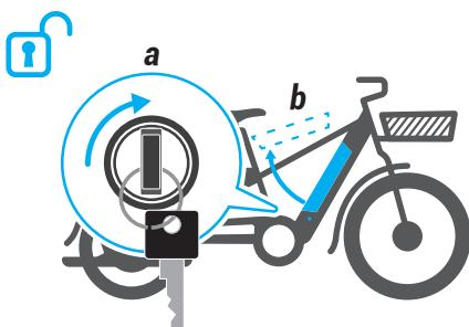
Před vyjmutím baterie z jejího pouzdra jej odemkněte klíčem. Podřížte kliček otočený a zatáhnutím za baterii ji vyjměte.
