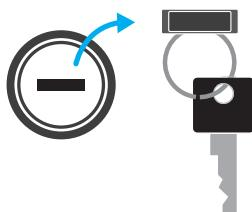
Försök inte att sätta i eller ta ur batteriet när det är låst (horisontellt läge), Du riskerar att förstöra batteriets säkerhetsslås.
