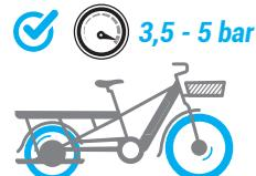
2. Die Reichweite und die Effizienz steigen bei einem Reifendruck von 3,5 bis 5 bar
