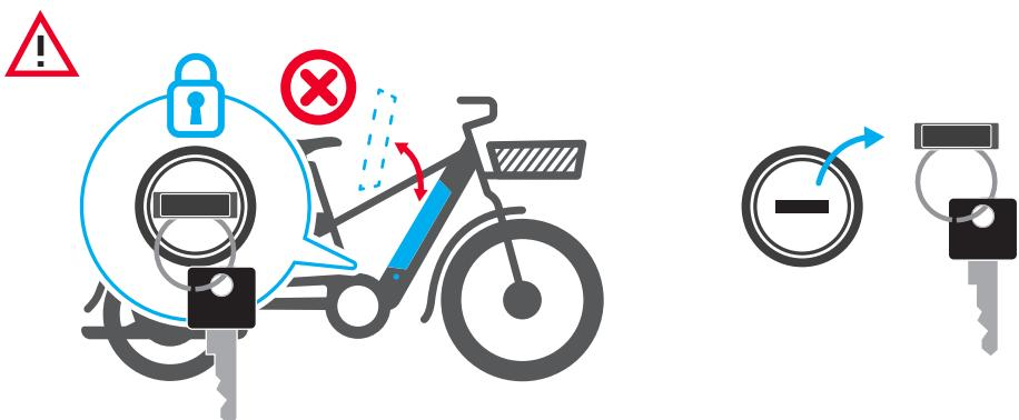
Per non correre il rischio di rompere la sicura della batteria, non tentare di inserire o rimuovere la batteria quando la sicura è bloccata (orizzontale).
