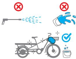
Ește interzisă spălarea cu jet cu presiune înaltă.
