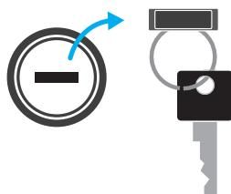
No intentes introducir o extraer la batería cuando el pestillo esté bloqueado (posición horizontal): Podrías romper la seguridad de la batería.
