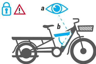
Než baterii vložíte do jejího umístění, zkонтrolujte, že se v uložení nenachází žádný cizí předmět nebo těleso.
