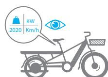
Hmotnosť, výkon, rok výroby a maximálna rýchlosť sú uvedené na ráme bicykla. Vzhľadom na to, že hmotnosť bicykla s elektrickým pomocným pohonom presahuje 15 kg, odporúčame, aby ho prepravovali 2 osoby.
