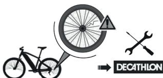
A motor által hajtott kerék szintén nagyobb igénybevételnek van kitéve, mint egy hagyományos kerékpár kereke, és a megerősítése ellenére előfordulhat a küllők törése. A küllők törése esetén keresse fel a DECATHLON áruházát.
