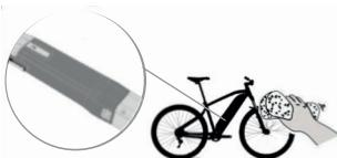
Alle Reinigungsarbeiten müssen unbedingt mit der Batterie am Fahrrad unternommen werden, aber das Fahrrad muss ausgeschaltet sein! Somit sind die Batterieanschlüsse abgedeckt und vor Wasser geschützt.
