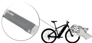
Todas as operações de limpeza devem ser feitas imperativamente com a bateria na bicicleta, mas com a bicicleta desligada! os conectores da bateria estarão escondidos e protegidos da água.
