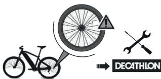
La ruota motorizzata è più sollecitata rispetto a una ruota di bicicletta classica e per questo, benché rinforzati, è possibile che i raggi si rompano. In caso di rottura di uno o più raggi rivolgersi al negozio DECATHLON più vicino.
