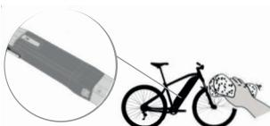
Orice operațiuni de spălare trebuie efectuate în mod obligatoriu având bateria pe bicicletă și având bicicleta dezactivată! conexiunile bateriei vor fi astfel ascunse și protejate de apă.
