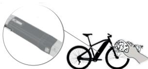
Todas las operaciones de limpieza deben efectuarse con la batería instalada, pero con la bicicleta apagada! De esta forma, los sistemas de conexión de la batería quedarán protegidos del agua.
