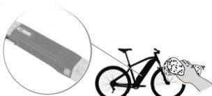
Todas las operaciones de limpieza deben efectuarse con la batería instalada, pero con la bicicleta apagada! De esta forma, los sistemas de conexión de la batería quedarán protegidos del agua.
