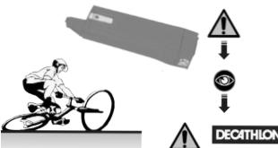
Überprüfen Sie nach einem Sturz des Fahrrades oder dem Herunterfallen des Akkus die Vollständigkeit des Akkus.
