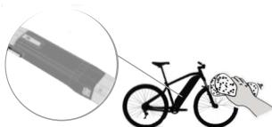
Bütün temizlik işlemleri batarya bisiklet üzerindeyken ancak bisiklet kapalıken yapılmalıdır! Böylece batarya bağlantıları gizlenmiş ve sudan korunmuş olacaktır.
