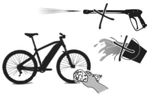
Verboden: reinigen met een hogedrukreiniger.
