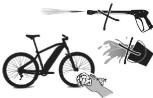
Este interzisă spălarea cu jet cu presiune înaltă.
