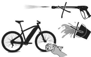
Prepovedano: čiščenje z visokotlačnim curkom
