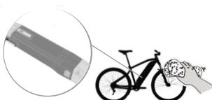
Kompletno čišćenje mora biti izvršeno s baterijom na biciklu koji je isključen! Tako će priključci baterije biti sakriveni i zaštićeni od vode.
