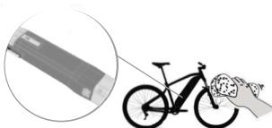
Minden tisztítási műveletet kikapcsolt kerékpárral, az akkumulátor kivétele nélkül kell elvégezni! Az akkumulátor csatlakozások így rejtve és víztől védetten maradnak.
