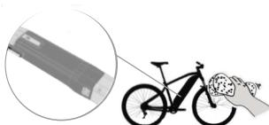
Tutti gli interventi di pulizia devono tassativamente essere eseguiti con batteria montata ma la bicicletta spenta! le connessioni della batteria saranno nascoste e protette dall'acqua.
