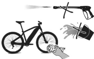
Interdit : nettoyage avec un jet haute pression.
