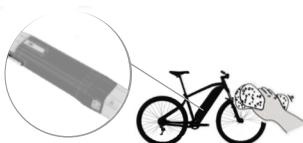
Orice operații de spălare trebuie efectuate în mod obligatoriu având bateria pe bicicletă și având bicicleta dezactivată! conexiunile bateriei vor fi astfel ascunse și protejate de apă.
