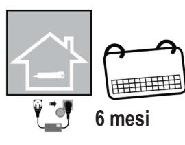
Nel caso in cui la batteria non dovesse essere utilizzata per lunghi periodi, effettuare comunque una ricarica completa una volta ogni 6 mesi.
