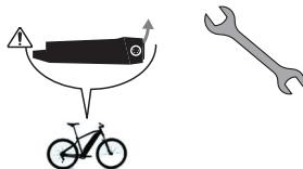
7. De batterij dient verwijderd te worden voor elke onderhoudsinterventie
