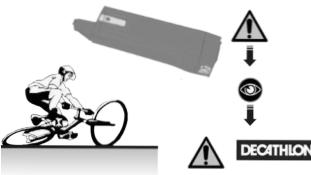
En caso de caída de la bicicleta o de la batería debes comprobar el buen estado de ésta. Ante un deterioro físico de la batería, hay que acudir a un taller de Décathlon para hacer un diagnóstico.
