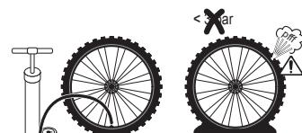
2. O risco de furo é grande se o pneu não estiver suficientemente insuflado
