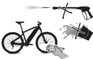
Tilos: nagynyomású vízsugárral végzett tisztítás.
