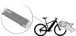
Svi radovi na čišćenju mogu se vršiti sa baterijom na biciklu, ali sa isključenim biciklom! Na taj način, priključci baterije će biti sakriveni i zaštićeni od vode.
