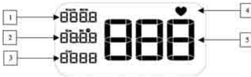
1. Visualizzazione della velocità di pedalata.
