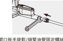
圖4-3 以8mm開口扳手旋鬆/鎖緊油管固定螺絲
