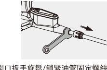
圖4-1 以8mm開口扳手旋鬆/鎖緊油管固定螺絲
