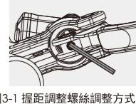
圖3-1 握距調整螺絲調整方式
