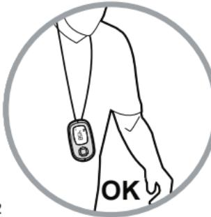
Этот шагомер предназначен для измерения различных параметров вашей ходьбы по ровной местности. Технически измерение производится путем регистрации волн, возникающих от удара ноги о поверхность, поэтому ваш шагомер должен крепиться на уровне бедра (на ремне брюк или шортов).
