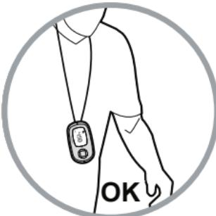
Krokometr je určen pro měření různých parametrů při chůzi v rovném terénu. Technicky je měření prováděno tak, že dochází k zaznamenávání jednotlivých rázových vln vznikajících při kontaktu nohy se zemí, z tohoto důvodu je nutné, abyste si krokometr připevnili v úrovni boků (pásek kalhot nebo šortek).
