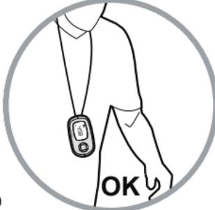
本产品适用于测量平坦路面上步行时的各项参数数据。从技术角度上讲，计步器是通过探测并记录用户足底与地面接触后震动产生的声波而完成测量，因此，使用中须将计步器佩戴于髋部部位（长裤或短裤腰带上）。
