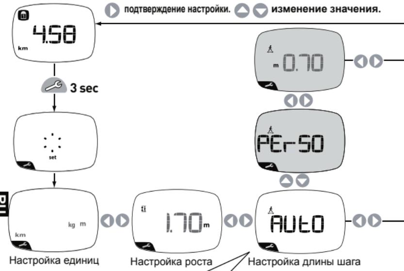
Расчет пройденного расстояния производится на основании длины шага.
