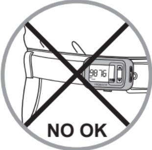
Krokoměr je určen pro měření různých parametrů při chůzi v rovném terénu. Technicky je měření prováděno tak, že dochází k zaznamenávání jednotlivých rázových vln vznikajících při kontaktu nohy se zemí, z tohoto důvodu je nutné, abyste si krokoměr připevnili v úrovni boků (pásek kalhot nebo šortek).
