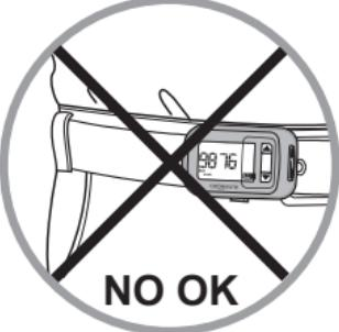
Der Pedometer ist angepasst, um die verschiedenen Parameter Ihres Gehens auf ebenem Boden zu messen. Technisch erfolgen diese Messungen indem die vom Kontakt Ihres Fußes mit dem Boden hervorgerufenen Schockwellen aufgezeichnet werden. Dies setzt eine Befestigung Ihres Geräts auf Hüfthöhe voraus (Hosengürtel oder Short).
