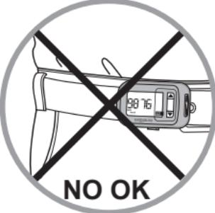
Този крачомер е предназначен да измерва параметрите на ходене по равен терен. Технически, тези измервания се извършват чрез регистриране на ударните вълни, предизвикани от контакта на крака ви със земята, което налага устройството да се носи на нивото на кръста (колан на панталон или шорти).
