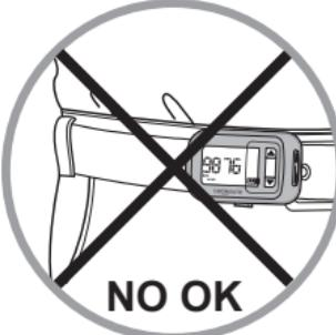
Ce podomètre est adapté pour mesurer les différents paramètres de votre marche sur terrain plat. Techniquement, ces mesures s'effectuent en enregistrant les ondes de chocs provoquées par le contact de votre pied avec le sol, cela impose une accroche de votre produit au niveau de la hanche (ceinture du pantalon ou short).
