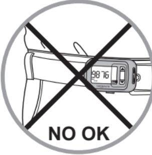
Этот шагомер предназначен для измерения различных параметров вашей ходьбы по ровной местности. Технически измерение производится путем регистрации волн, возникающих от удара ноги о поверхность, поэтому ваш шагомер должен крепиться на уровне бедра (на ремне брюк или шортов).
