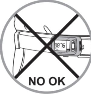
Questo contapassi è adatto per misurare i diversi parametri della marcia su terreno piano. Tecnicamente, queste misure si effettuano registrando le onde d'urto provocate dal contatto del vostro piede con il suolo: questo impone di agganciare il prodotto a livello dell'anca (cintura dei pantaloni o dei calzoncini).
