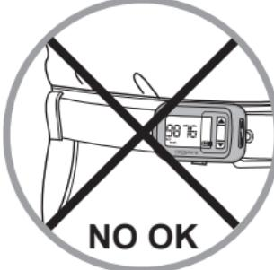
Krokometr jest przeznaczony do pomiaru różnych parametrów marszu w płaskim terenie. Z technicznego punktu widzenia, pomiar jest przeprowadzany poprzez zapis fal uderzeniowych spowodowanych kontaktem stopy z podłożem, w tym celu urządzenie musi być noszone na wysokości bioder (zaczepione do paska spodni lub szortów).
