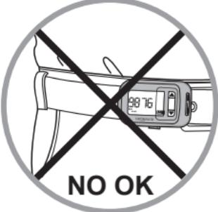
Stegräknaren är framtagen för att mäta olika parametrar hos din gång på plan mark. Rent tekniskt sker mätningarna genom registreringen av de stötvågor som uppstår när foten kommer i kontakt med marken. Detta förutsätter att enheten fästs på höften (i byxlinningen).
