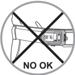
本产品适用于测量平坦路面下步行时的各项参数数据。从技术角度上讲，计步器是通过探测并记录用户足底与地面接触后震动产生的声波而完成测量，因此，使用中须将计步器佩戴于髋部部位（长裤或短裤腰带上）。
