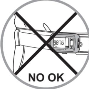
El podómetro está adaptado para medir los diferentes parámetros de una caminata en terreno llano. Técnicamente, estas mediciones se realizan registrando las ondas de choque provocadas por el contacto del pie con el suelo, por eso se debe colocar el producto en la cadera (en la cintura de los pantalones o bermudas).
