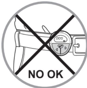
Този крачкомер е предназначен да измерва параметрите на ходене по равен терен. Технически, тези измервания се извършват чрез регистриране на ударните вълни, предизвикани от контакта на крака ви със земята, което налага устройството да се носи на нивото на кръста (колан на панталон или шорти).
