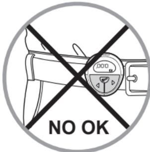
Tento pedometr je přizpůsoben pro měření nejrůznějších parametrů chůze na rovném terénu. Technicky měření probíhá tak, že přístroj registruje rázové vlny vyvolané kontaktem nohy s terémem, z tohoto důvodu je nutné přístroj připevnit na tělo na úrovni boků (na opasek kalhot nebo šortek).
