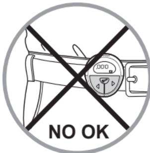
Acest podometru este conceput pentru a măsura diferenții parametri ai mersului dumneavoastră pe un teren plat. Din punct de vedere tehnic, aceste măsurători se efectuează prin înregistrarea undelor de șoc provocate de contactul piciorului cu solul; din acest motiv, trebuie să fixați produsul la nivelul șoldului (la curea pantalonilor sau la betelia pantalonilor scurți).
