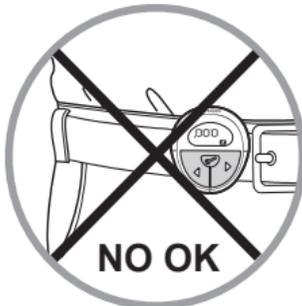
Этот шагомер предназначен для измерения различных параметров вашей ходьбы по ровной местности. Технически измерение производится путем регистрации волн, возникающих от удара ноги о поверхность, поэтому ваш шагомер должен крепиться на уровне бедра (на ремне брюк или шорт).
