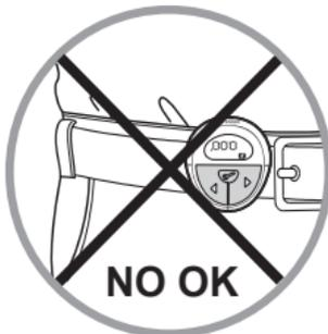
Krokomierz jest przeznaczony do pomiaru różnych parametrów marszu w płaskim terenie. Z technicznego punktu widzenia, pomiar jest przeprowadzany poprzez zapis fal uderzeniowych spowodowanych kontaktem stopy z podłożem, w tym celu urządzenie musi być noszone na wysokości bioder (zaczepione do paska spodni lub szortów).
