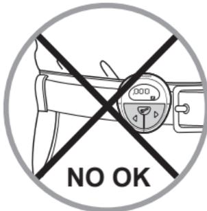
De podometer is geschikt voor het meten van verschillende waarden tijdens het lopen op een vlak terrein. De techniek bestaat eruit dat het apparaat de metingen verricht door de schokgolven te meten die ontstaan wanneer de voet de grond raakt. Het product dat zich ter hoogte van uw heup bevindt (broekriem of bovenste rand short), ontvangt een impuls. Dit product is niet geschikt voor het hardlopen, of wandelingen op heuvelachtig.
