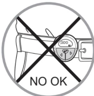
本產品適用於測量平坦路面下步行時的各項參數數據。從技術角度上講，計步器是通過探測並記錄用戶足底與地面接觸後震動產生的聲波而完成測量，因此，使用中須將計步器佩戴於腰部位置（長褲或短褲腰帶上）。
