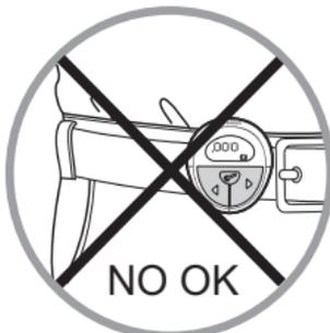
本产品适用于测量平坦路面下步行时的各项参数数据。从技术角度上讲，计步器是通过探测并记录用户足底与地面接触后震动产生的声波而完成测量，因此，使用中须将计步器佩戴于腰部部位（长裤或短裤腰带上）。
