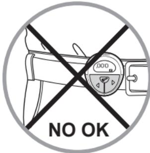
Dieser Pedometer ist angepasst, um die verschiedenen Parameter Ihres Gehens auf ebenem Boden zu messen. Technisch erfolgen diese Messungen indem die vom Kontakt Ihres Fußes mit dem Boden hervorgerufenen Stoßwellen aufgezeichnet werden. Dies setzt eine Befestigung Ihres Geräts auf Hüfthöhe voraus (Hosengürtel oder Short).
