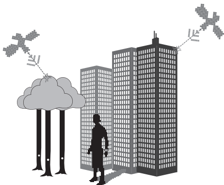
Mauvaises conditions de réception satellite.
